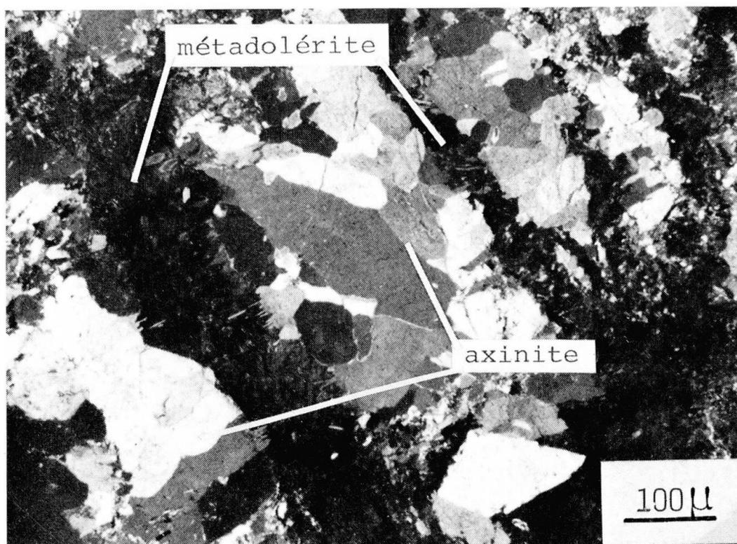
Fig. 5 Micrographie optique de l'axinite en filonnets (variété 2) (lumière polarisée).
