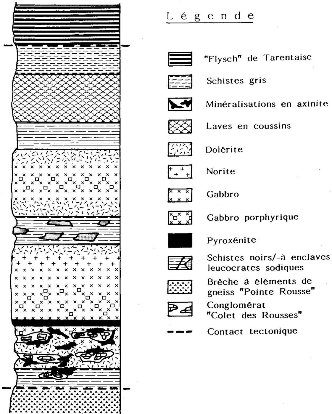
Fig. 3 Succession lithologique idéalisée et schématique du secteur de la Pointe du Clapey (revue et complétée d'après LOUBAT, 1975).
