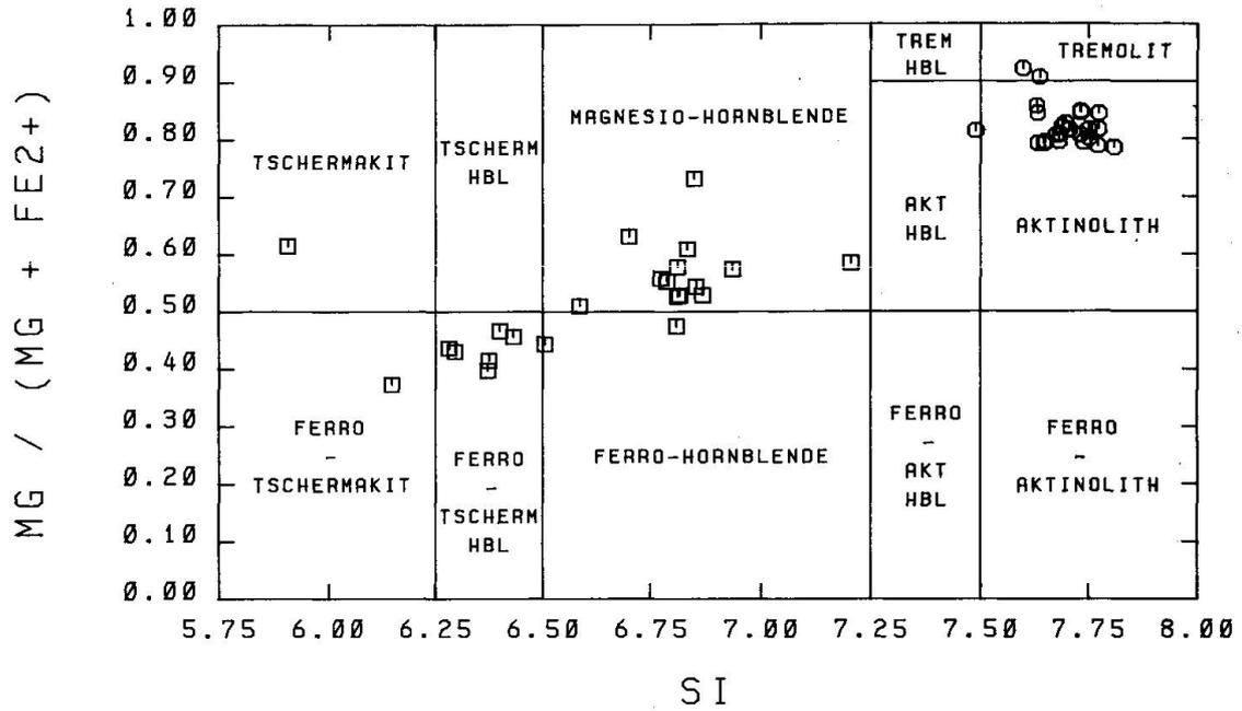
Abb. 5 Ca-Amphibol-Diagramm nach LEAKE (1978) für  $(Na+K)_A < 0.50$  und  $Ti < 0.50$ .
