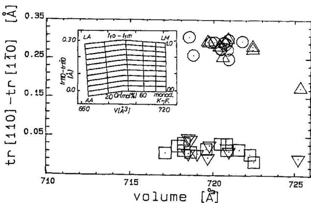
Fig. 8 Indice  $tr [110] - tr [1\bar{1}0]$  de KROLL (1973) en fonction du volume molaire: estimation graphique des différences de probabilités d'occupation des sites T1O et T1M. La figure montre le domaine de variations T1O-T1M des feldspaths potassiques. Encart: AA = Analcite; LA = Low albite; LM = Low microcline; monoc. KF = KF topochimiquement monoclinique (KROLL et RIBBE, 1983).
