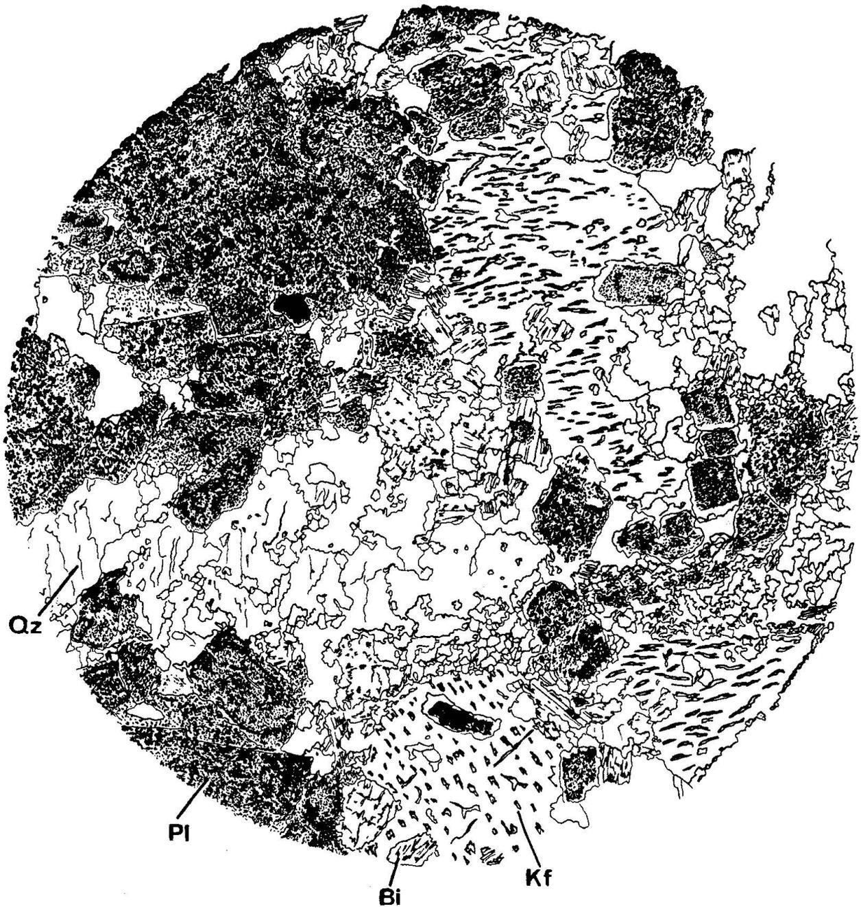
*Fig. 2* Texture du granite de Medel non déformé de la bordure nord du complexe intrusif (M108). La texture massive et hétérogranulaire montre les phénocristaux idiomorphes de feldspath potassique et des plagioclases saussuritisés en agrégat de prismes imbriqués. Les interstices sont remplis par le quartz et les paillettes enchevêtrées de biotite brune. Autres explications dans le texte.
