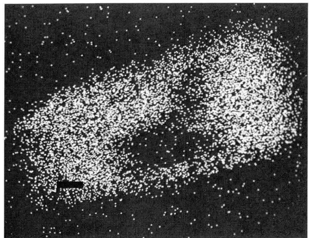
Fig. 3 Image X de l'antimoine; le tiret = 15 µm.
