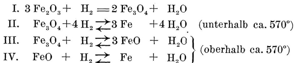
Die Reaktion I ist zufolge des hohen Zersetzungsdruckes von Fe<sub>2</sub>O<sub>3</sub> praktisch irreversibel; die übrigen drei Vorgänge sind umkehrbar. Die Temperaturgrenze von zirka 570° ist dadurch bedingt, dass FeO (Wüstit) nur oberhalb zirka 570° beständig ist und unterhalb dieser Temperatur zu Fe<sub>3</sub>O<sub>4</sub> und Fe zerfällt.
