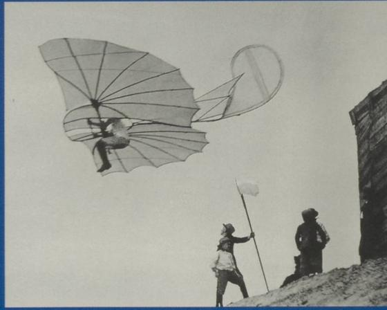
Die Wölbung zwingt den Luftstrom auf der Flügeloberseite zu einem weiteren Weg und damit zu höherer Geschwindigkeit. Es entsteht ein Unterdruck im Vergleich zur Flügelunterseite und damit eine Sogwirkung, die den Flügel anhebt.
