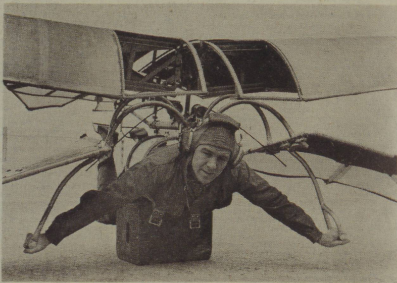
Fliegen aus eigener Kraft: Rudolf Abbühl mit seinem selbstkonstruierten Muskelkraft-Flugzeug. Mit den Armen bewegt der Pilot zwei Schwingflügel, welche den Auftrieb liefern sollen Bild: Varrone
