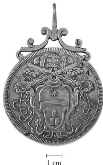
Fig. 5 Campione 456. Localizzazione dei punti di campionamento: 1. montatura abrasa; 2. brasatura; 3. pasta moneta abrasa; 4. pasta moneta tal quale.
