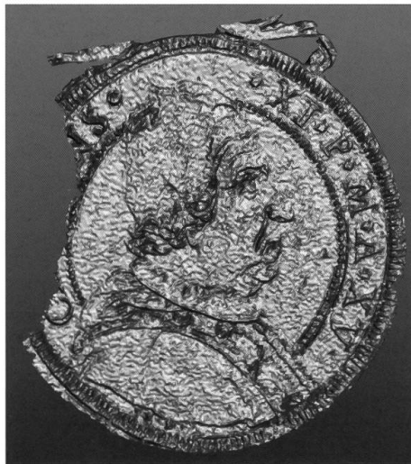
Fig. 17 Fase di meshing , ovvero il passaggio dalla nube grezza di punti 3D ad un reticolo di poligoni connessi tra loro i cui vertici coincidono con i punti misurati.
