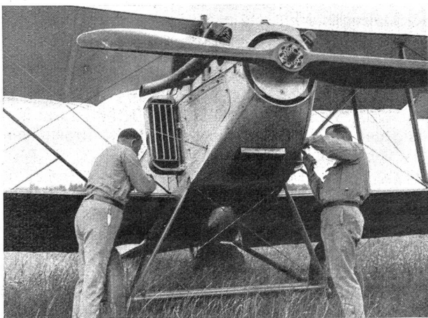
S. U. T. Genf. Wettübungen der Fliegertruppe: Demontage eines Flugzeuges. Nach dem Kommando: „An die Arbeit!“ werden die verschiedenen Kabel der Tragflächen gelöst. — J. S. S. O. Genève. Exercices pour pionniers-aviateurs: Démontage d'un avion. Après le commandement « au travail! » on détache les câbles-porteurs des ailes.
