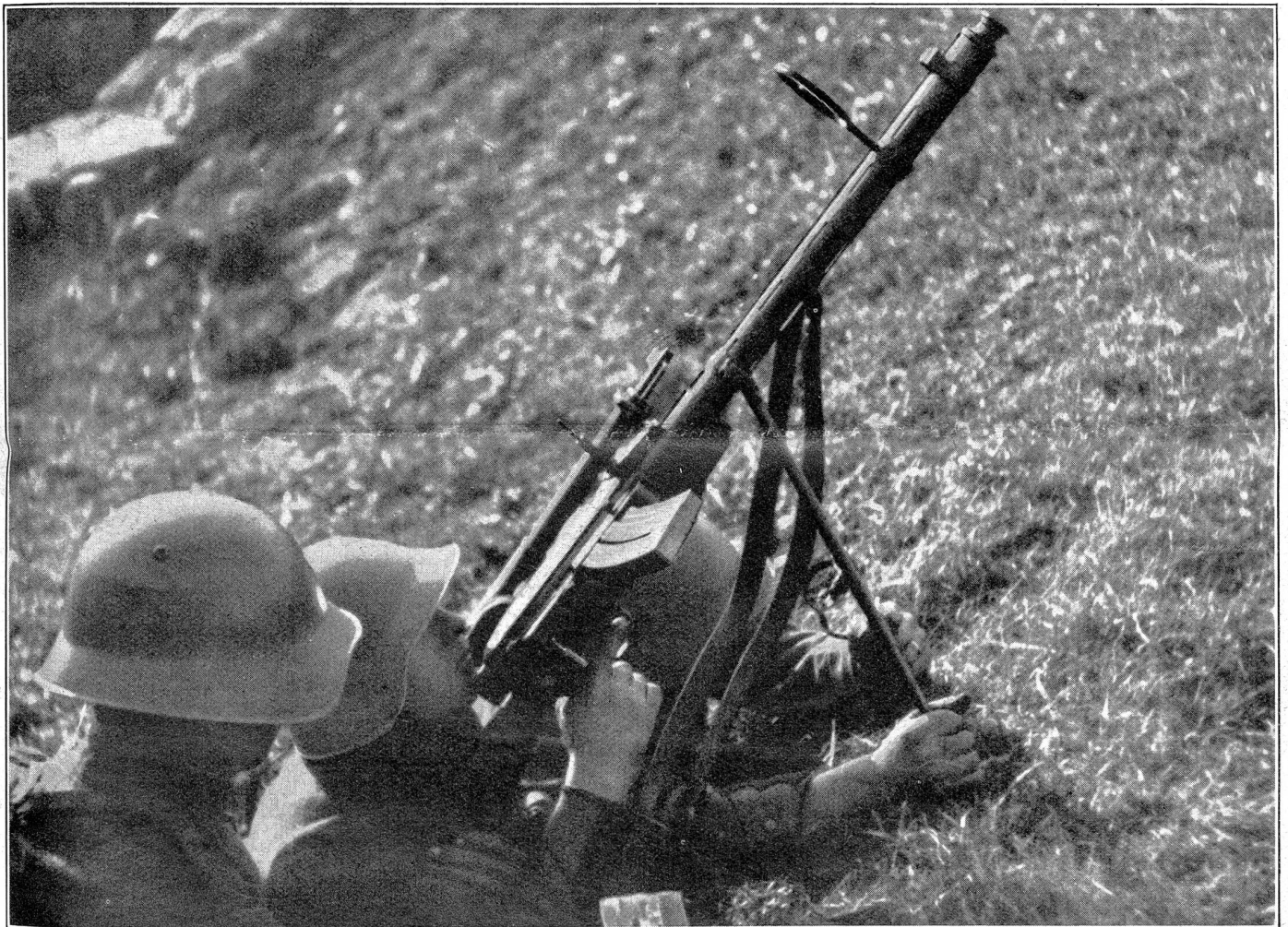
Bild 8. Wenn man beim Lmg. die Vorderstütze zurückschiebt, erreicht man einen relativ steilen Schußwinkel
