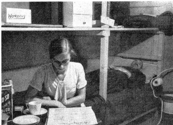
Passiver Luftschutz. Luftschutz-Raum. Zweck der Luftschutzräume wird sein, sowohl vor Bombengasen, wie auch vor Bombensplittern Schutz zu bieten. Unser Bild gibt einen guten Überblick, wie ein solcher Luftschutzraum einzurichten ist: Lagerstellen für Kranke und Gebrechliche, Proviant, Eßgeschirr, Werkzeug, eine Notapotheke, eine Nottoilette, elektrische Taschenlampen usw. werden für den vielleicht auf Stunden sich ausdehnenden Aufenthalt im Luftschutzraum nötig sein.
