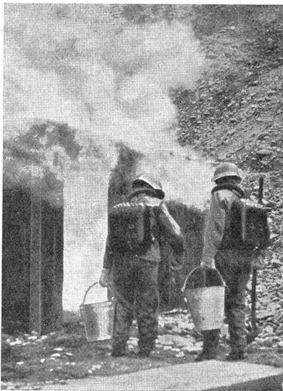
**Passiver Luftschutz. Versuche mit Brandbomben.** Die Löschmannschaft dringt, mit dem Sauerstoffgerät ausgerüstet, zum Brandherde vor und löscht diesen durch Ersticken mit Sand.
