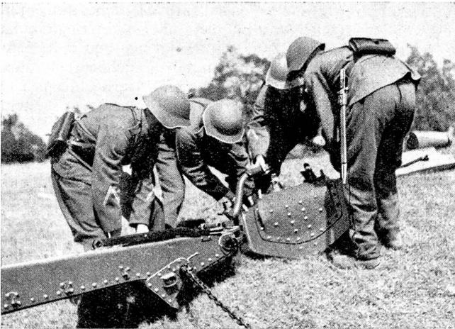
In der Feuerstellung erhält jede der beiden Lafettenspreizen einen Sporn angesetzt, der rund 40 cm in den Boden eingegraben, die Rückstoßwirkung des Schusses auffängt.
