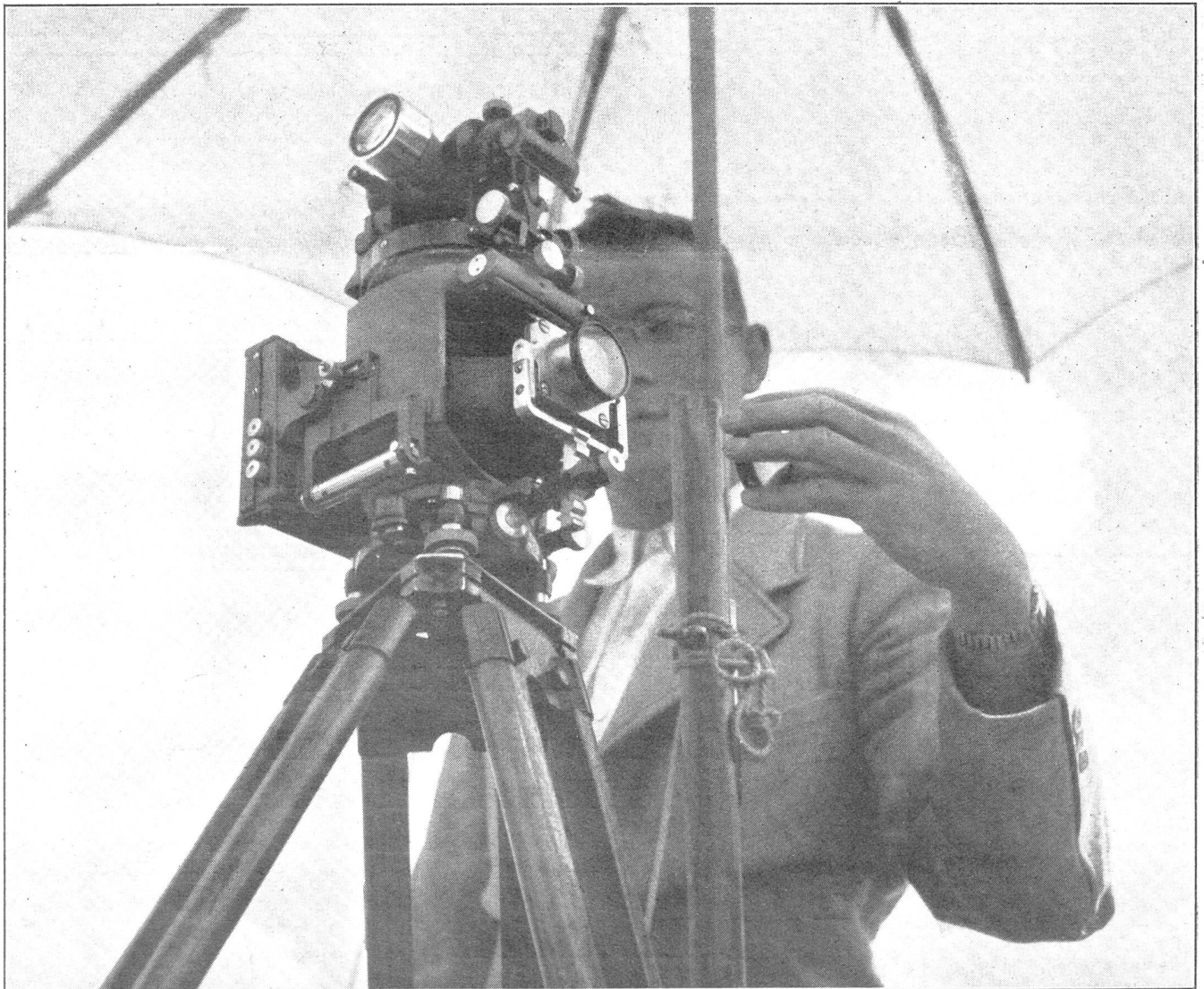
Vom Entstehen unserer Landkarten. Photogrammeter bei der Aufnahme eines Geländeabschnittes; Zeit-Exposition der Aufnahme. Phot. K. Egli, Zürich. Travaux préparatoires pour l'établissement de nos cartes topographiques. Prise de vue photogrammétrique d'un secteur de terrain. Temps d'exposition. Come sorgono le nostre carte geografiche. Fotogrammetrico alla presa fotografica di un settore di terreno. Esposizione a tempo.
