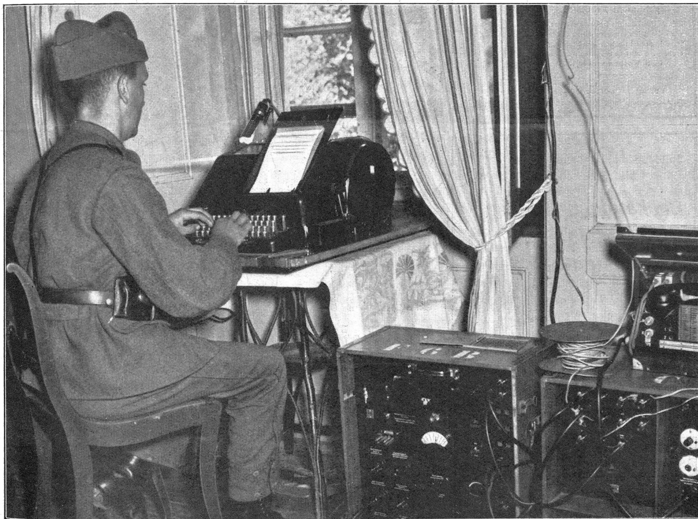
TL-Station im Betrieb. Telegraphen-Pionier am Schreibtelegraphen (Fernschreiber). Station de télégraphie en action. Pionnier-télégraphiste au travail (télé-imprimeur). Stazione telegrafica militare. Pionieri telegrafisti al lavoro.
