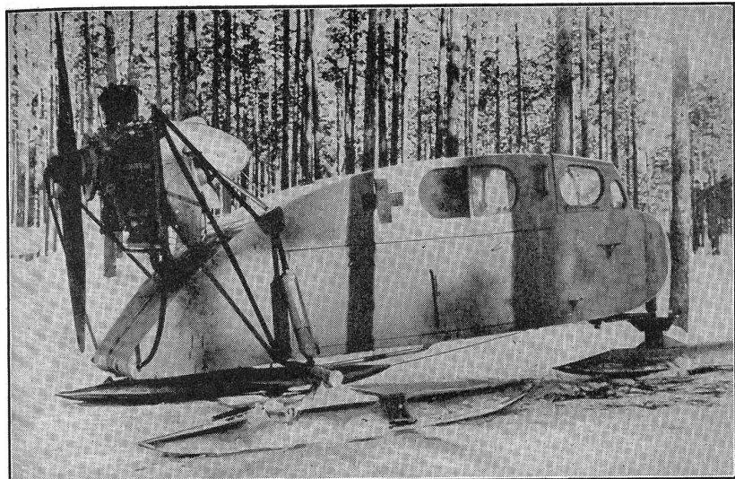
Gepanzerter Eisschlitten mit Propellerantrieb für 2 Mann und 1 Mg., wie sie am Ladogasee eingesetzt wurden. Die Schlitten zur Irreführung des Gegners mit dem Roten Kreuz versehen.
