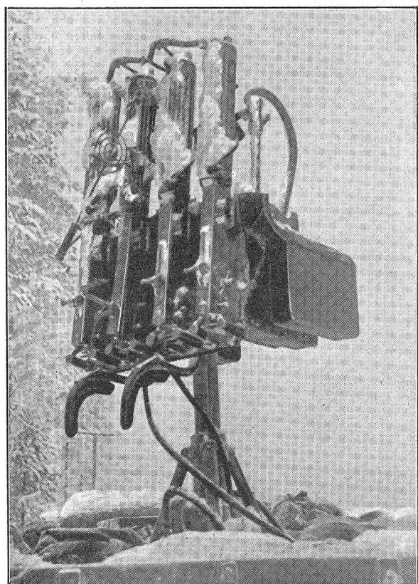
Vierfaches russisches Flabmaschinengewehr, System Maxim, mit offener Gurtenzuführung, fest auf Lastwagenbrücke montiert.
