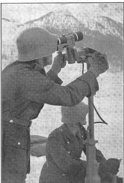
Das Kommandogerät der 34-mm-Flab ist sowohl in Konstruktion wie Handhabung sehr einfach gehalten. (VIB 1015.) L'appareil de pointage du canon 34 mm D.C.A. est aussi simple de construction que de manèment. Il congegno di punteria del pezzo a aer. da 34 mm risulta della massima semplicità tanto nella costruzione che nel maneggio. Rechts: Batteriechef und Telemeterbedienung einer 34-mm-Flab-Batterie während des Beschlusses eines Luftzieles. (VIB 1012.) A droite: Le chef de batt. et le servent du télémètre d'un canon 34 mm pendant le tir contre un but aérien. A destra: Il Cdt. di batteria e la squadra addetta al telemetro, durante il tiro di una batteria da 34 mm.
