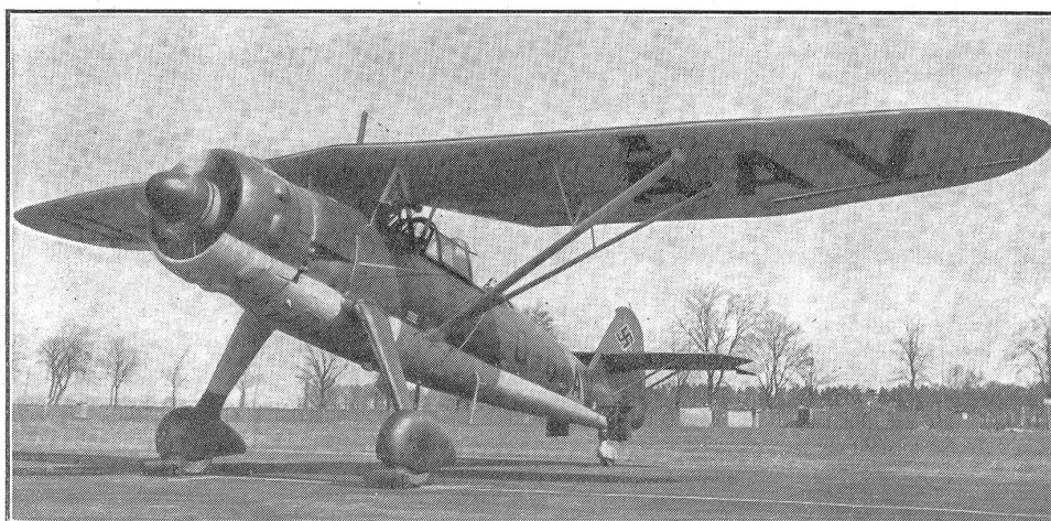
Avion d'observation rapprochée allemand (Type Henschel Hs 126) équipage: 2 hommes. Moteur en étoile de 830 HP.; 1 mitr. fixe et 1 mitr. mobile; crochets pour 10 bombes à 10 kg.
