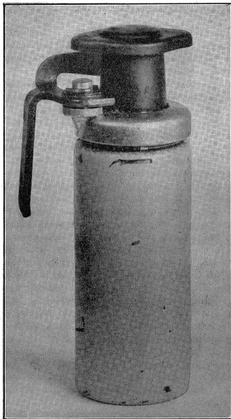
Die schweizerische Offensiv-Handgranate Modell 1917/25 und deren Längsschnitt. (Zensur-Nr. A Er 0221.)
