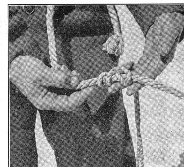
Bild 4. Der Gleitknoten. Belastet haftet dieser Reepschnurknoten unbeweglich am Partiseil, entlastet ist er leicht zu verschieben, daher wichtig für den Steigbügel. (A N 0276.)
