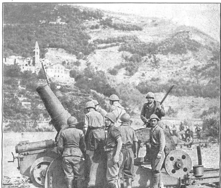
21-cm-Mörser M.D.S. 210/8. Gewicht in Feuerstellung 7800 kg; Geschößgewicht 101 kg, V o 347 m; Schußweite 8,4 km.
