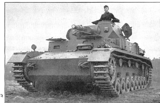
Bild 8. Schwerer Panzer-Kampfwagen (5 Mann Besatzung; 6 Doppellaufträder; Bewaffnung: 1 Geschütz von min. 7,5 cm und mehrere Mg.).
