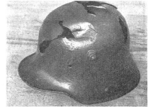
Wirkung großer Granatsplitter auf einem deutschen Stahlhelm. (Hartmannswellerkopf.)
