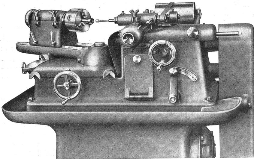
Machine à rectifier les intérieurs
