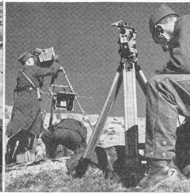
Theodoliten von 30 zu 30 Sekunden der genaue «Standort» der Radiosonde in der Luft gemessen werden. So erhält man von den verschiedenen Luftschichten genaue Angaben bis zur gewünschten Höhe. (V/V 13443)
