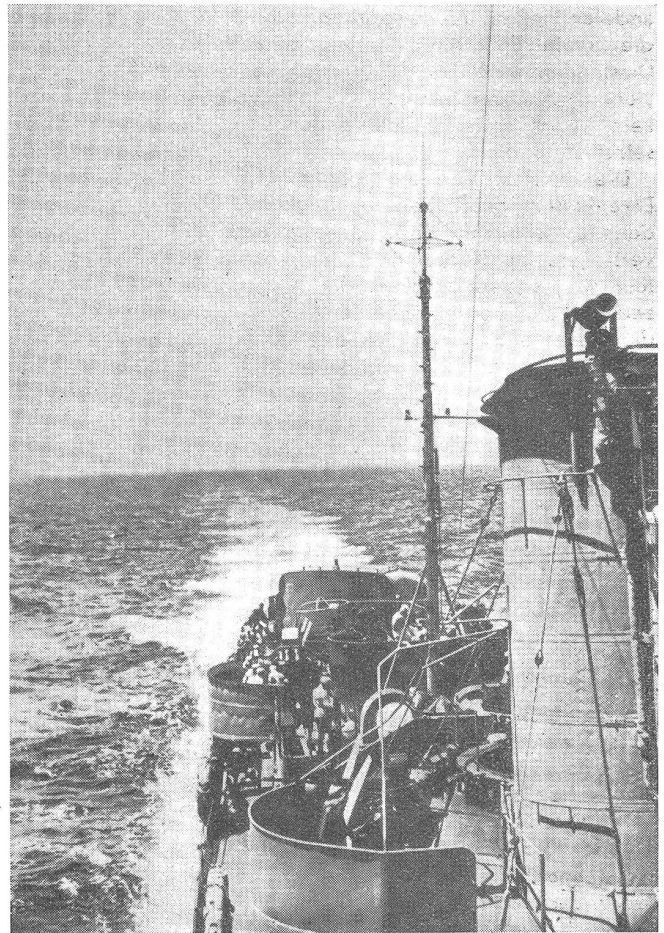
Die Apparatur auf der Mastspitze des Zerstörers, die aussieht wie eine Kombination von Papierdrachen und Regenschirm, ist die Antenne des Hochfrequenz-Elektronen-Detektors.
