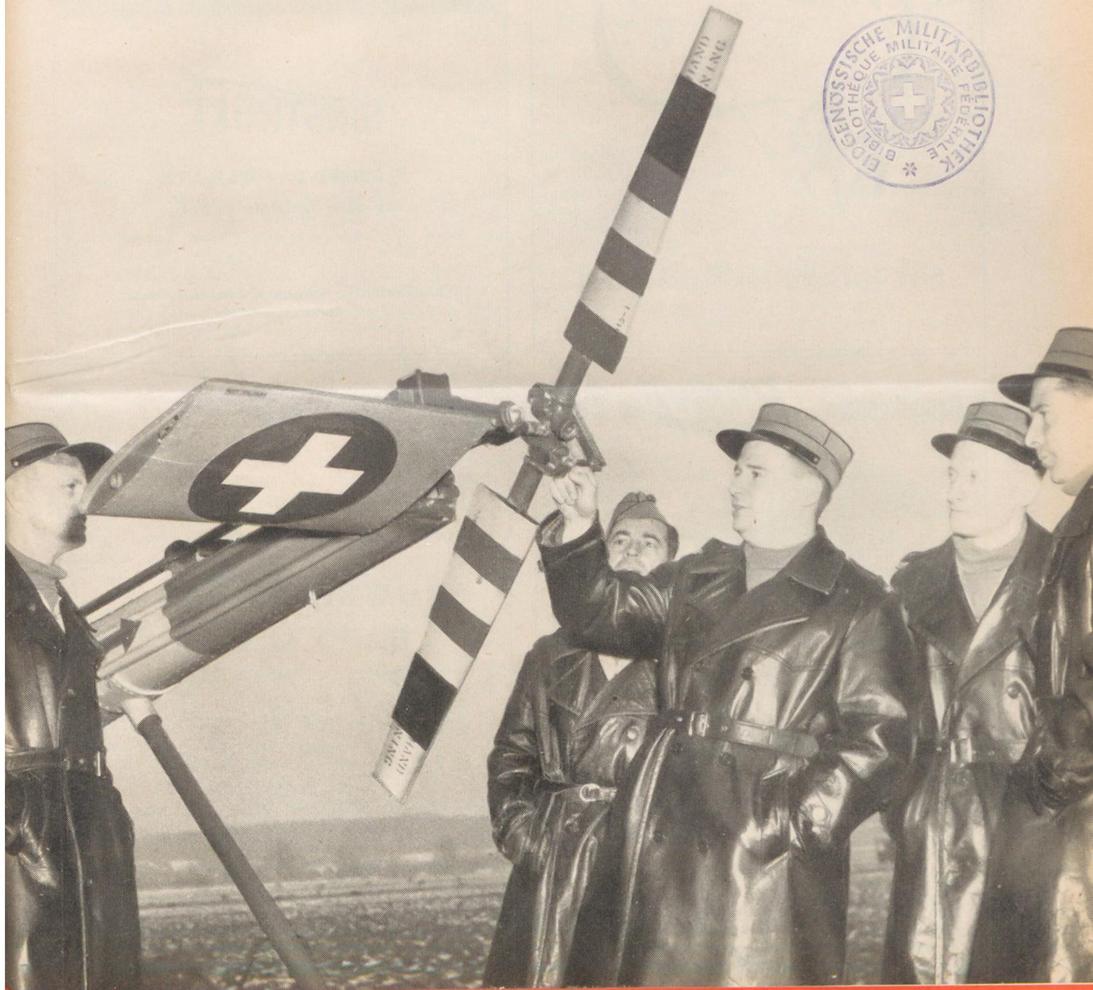
Unser Titelbild: Theorie am Helikopter. Die ungewohnte Maschine, die den Propeller auf dem Rücken statt an der „Nase“ hat, und deren Schwanz ein halbes Höhensteuer und einen zweiten Propeller, den Stabilisator, aufweist, wird eingehend studiert.
