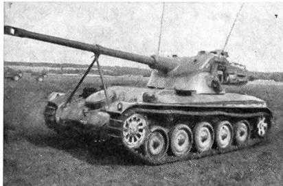
Auf dem Kampfwagen können 36 Schuß 7,5-cm-Munition, 2100 Schuß MG-Munition sowie HG und MP mitgeführt werden. Beim Schießen werden die 7,5-cm-Hülsen automatisch aus dem Panzer geworfen. Das Richten erfolgt hydraulisch oder mechanisch mittels eines Zielfernrohres.
