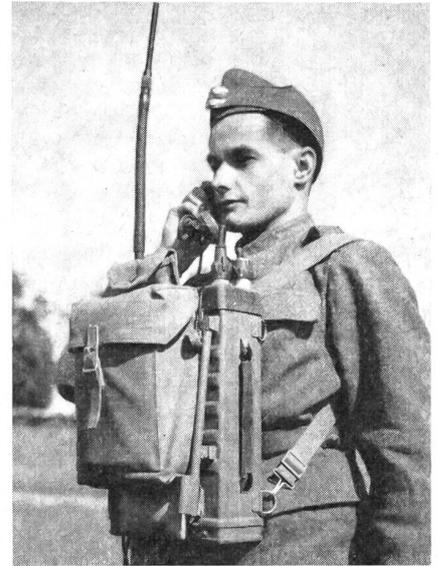
Die Schweizer Armee wird mit einem frequenzmodulierenden Kleinfunkgerät SE 206—209 ausgerüstet, das als Verbindungsmittel auf kürzere Distanzen (5 bis 20 Kilometer) sämtlichen Waffengattungen gute Dienste leisten wird. Das 11,3 Kilo schwere Gerät ist tragbar und kann mit einem Zusatzgerät als stationäre Anlage auf einem Jeep verwendet werden. (Photopress)
