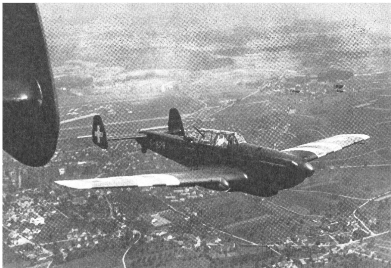
Der in den Eidg. Flugzeugwerken hergestellte C-36 löste den C-35 als Erdkampf- und Aufklärungsflugzeug ab. Max. Geschwindigkeit 470 km/h, Gipfelhöhe 10 000, Reichweite 680 km, Bewaffnung 4 Mg, wovon 2 für den Beobachter, eine Kanone zu 20 mm sowie Spreng-, Splitter- und Brandbomben.
