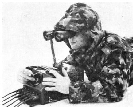
2 MOSQUITO-Schütze am Lenkgerät, an welchem sechs Lenkwaffen angeschlossen sind. Der Schütze wählt die zu startende Lenkwaffe durch Betätigung der Wahl-taste und startet die vorgewählte Lenkwaffe durch Druck auf die Starttaste (Bild). Mittels eines Lenkknüppels wird die Lenkwaffe nach dem Zieldeckungsverfahren ins Ziel gebracht.
