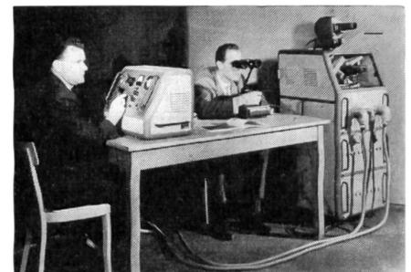
6 MOSQUITO-Trainingsanlage. Der Schütze lenkt mit seinem Lenkgerät die Lenkwaffe, welche durch einen Lichtpunkt vom Simulator auf eine Projektionswand dargestellt wird, nach den Weisungen seines Lehrers. Dieser kann am Kommandopult alle gewünschten Einflüsse wie z. B. Wind, Startwinkel, Ziel-geschwindigkeit, Entfernung des Zieles etc., einstellen. Schon nach wenigen Übungs-stunden an der Trainingsanlage ist der Schütze in der Lage, Lenkwaffen mit guter Treffererwartung zu starten.
