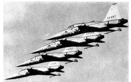
Uberschalljäger vom Typ F-5 im Formationsflug. Dank ihrer guten Steigfähigkeit ist der Höhenbereich um 12 000 m bereits nach vier Minuten erreicht. An den Flügelspitzen sind Fernlenk Waffen montiert.
