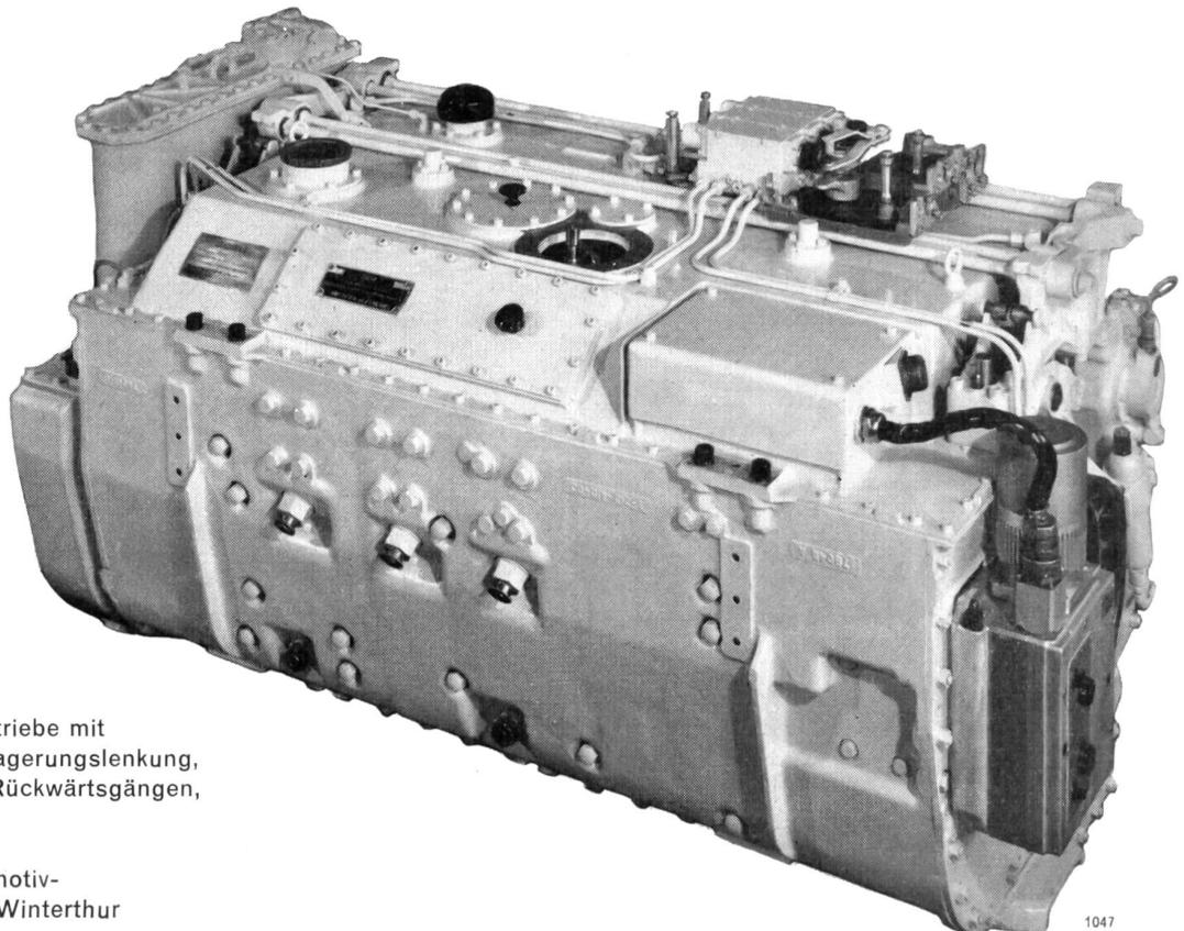
Lamellenkupplungsgetriebe mit hydrostatischer Überlagerungslenkung, 6 Vorwärtsgängen, 2 Rückwärtsgängen, 1 Anortgang
