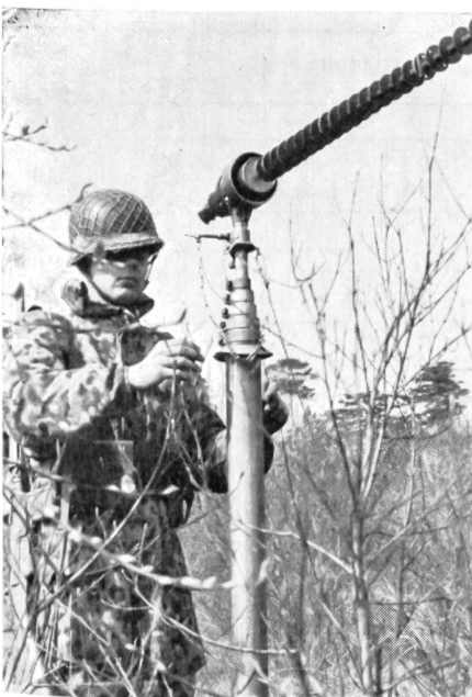
Richtfunkgerät mit «Zigarrenantenne»
