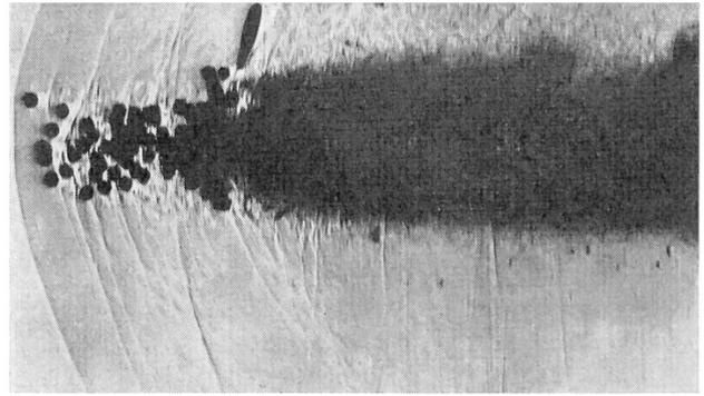
Ein Schrotschuß hat die Flinte verlassen. Die Photographie gibt ein plastisches Bild vom Verhalten der Schrotladung außerhalb des Laufes. Je mehr die einzelnen Schrotkugeln aus den anfangs gleichschnell strömenden Pulvergasen heraustreten, um so kräftiger ziehen sie eine «Kopfwelle» hinter sich her, voraus eilt die Mündungsknallwelle.
