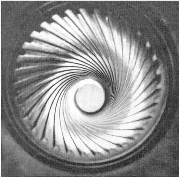
Der Blick in ein Kanonenrohr zeigt die schraubenförmig gewundenen Züge, die dem Geschöß eine rasche Drehung um seine Längsachse aufzwingen. Diese Bewegung nennt man «Drall». Er erst machte die Verwendung von Langgeschossen möglich, weil er das Ueberschlagen verhindert und dem Geschöß zu einem ruhigen, stabilisierten Flug verhilft.
