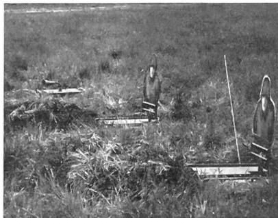
Die Zielscheibe ist ein Gerät, das bei einem Treffer automatisch umfällt. Sie kann durch automatische Fernsteuerung wieder zum Stehen gebracht werden. Die Zielanlage kann bei Fernsteuerung mit einem Maschinengewehrsimulator (links) gekoppelt werden.
