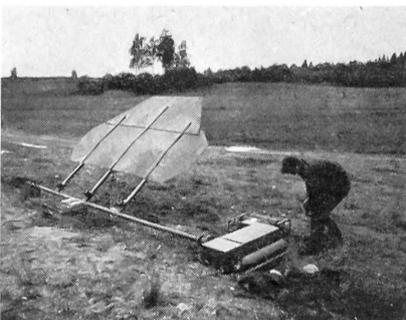
Wenn ein Kampfwagenziel aufgerichtet wird, gleicht dieses einem Panzerwagen, der plötzlich auftaucht. Die Attrappe verfügt über einen Rauchanzeiger, der automatisch bei einem Treffer einen Rauchpilz auslöst. All die Kommandos erfolgen auch hier ferngesteuert.
