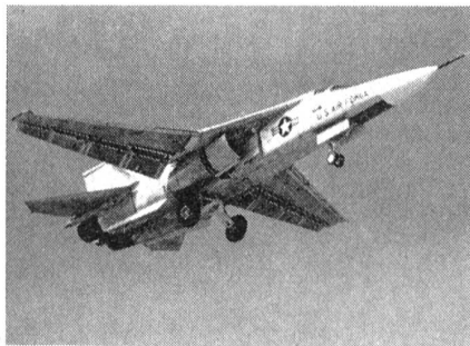
Die F-111 im Langsamflug mit weitausladender Stellung des Flugwerkes (Flügel), ca. 16 Grad Flügelpfeilung.
