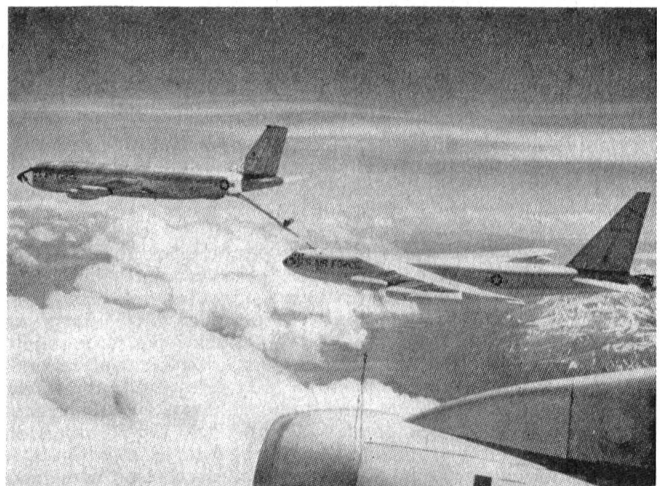
Eine KC-135-Tankermaschine betankt einen B-52-Bomber hoch über den Wolken. Die KC-135 ist eine SAC-Version der zivilen Boeing 707.
