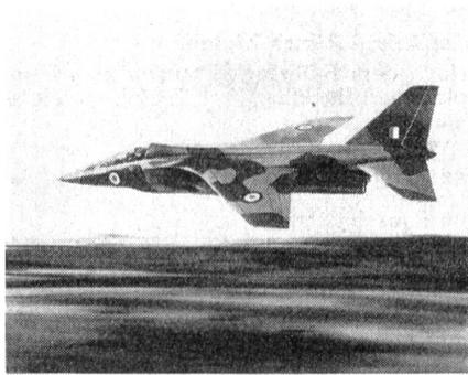
Von einem anglo-französischen Firmenkonsortium entworfen, steht die «Jaguar» gegenwärtig in fortgeschrittenem Entwicklungsstadium. Der Prototyp wird im März 1968 zum Erstflug starten. Das Flugzeug ist mit zwei Triebwerken ausgerüstet und erreicht Ueberschallgeschwindigkeit (Mach 1,7). An militärischen Lasten können 4,5 Tonnen mitgeführt werden.
