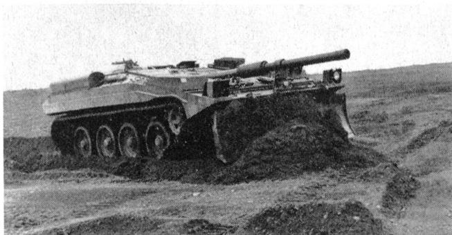
Dieser Panzer ist auch sein eigener Bulldozer, er kann sich selbst eingraben oder auch zum Ausheben von Gräben für schnelle Feldbefestigungen Verwendung finden. Mit einer mitgeführten Schwimmausrüstung können auch Flußläufe überquert werden.
