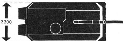
Das ist die bemerkenswerte Entwicklung des schwedischen Panzers S der Firma Bofors, der ohne Turm eine große Geschwindigkeit und Geländegängigkeit entwickelt und auf die Entfernung infolge seiner flachen Form schwer zu sehen ist. Er verfügt über eine Besatzung von 3 Mann, kann vorwärts und rückwärts fahren, hat ein Gesamtgewicht von 37 Tonnen und ist mit einer 105-mm-Kanone von hoher Präzision und mit zwei Maschinengewehren ausgerüstet.
