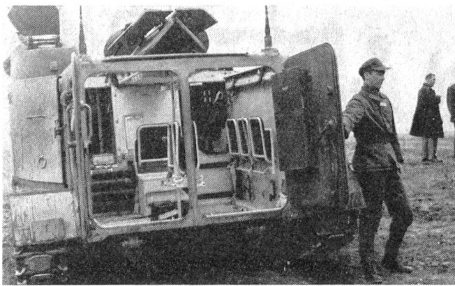
Einsicht in den neuen Mannschaftstransportwagen mit nach hinten geöffnetem Ausstieg.
