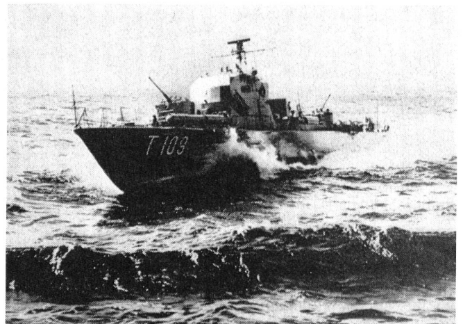
Schnellboot «Antares» auf hoher See. Ein Boot von 150 Tonnen, zwei automatischen Kanonen und einer sehr hohen Geschwindigkeit.
