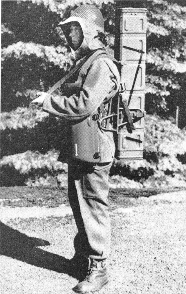
Auch in der Schweiz bekannt und eingeführt ist die Panzerabwehrrakete «Bantam» der Boforswerke, deren Abschubeinrichtung von einem Mann getragen werden kann und die nicht mehr als 19 kg wiegt. Die Rakete wird mittels Draht direkt ins Ziel gelenkt und verfügt mit hoher Präzision und Wirkung über eine Schußweite bis zu 2000 m.
