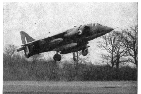
Es ist zum Senkrecht-in-die-Lüfte-Gehen — mit dem Harrier. Dieser erste truppenreife Senkrechtstarter der westlichen Welt ist zum Einsatz auf vorgeschobenen Behelfs-flugplätzen konzipiert. Er tritt 1969 in den Staffeldienst bei der Royal Air Force und ist als Ersatz der Hunter gedacht.
