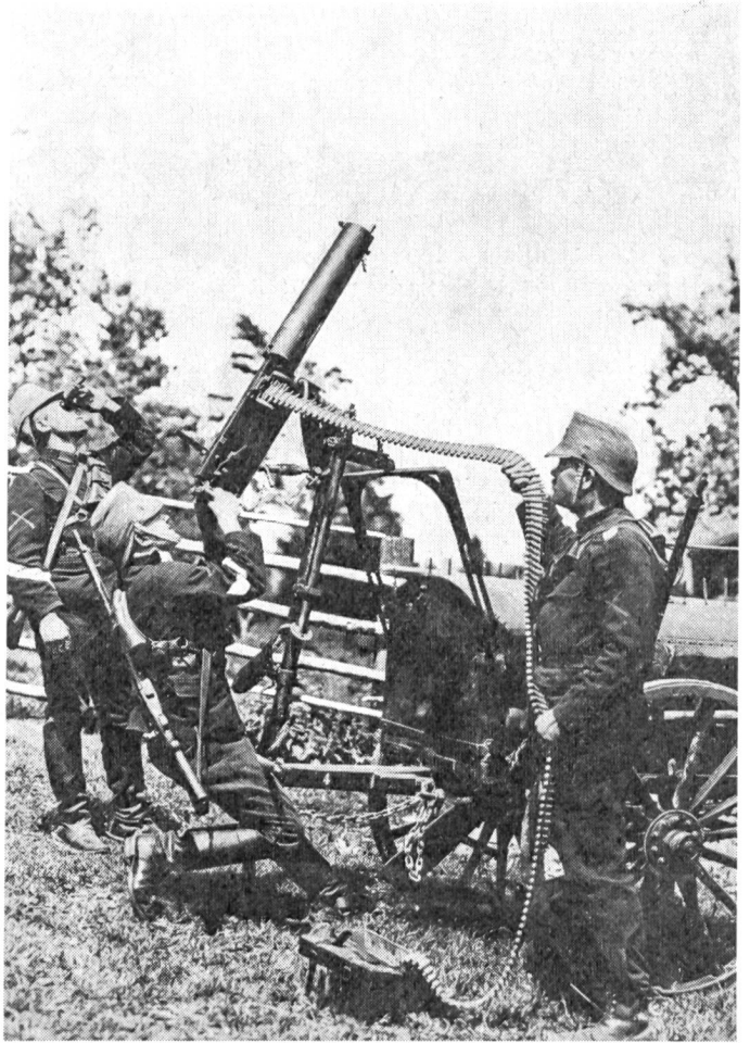
Im Pruntruter Zipfel waren Grenzverletzungen durch deutsche und französische Flieger an der Tagesordnung. Zur Fliegerabwehr wurden alle möglichen Konstruktionen ausprobiert. Hier haben Kavalleristen die Fliegerabwehrlafette auf einen Munitionscaisson montiert und schiessen mit dem Maschinengewehr auf fremde Flugzeuge.
