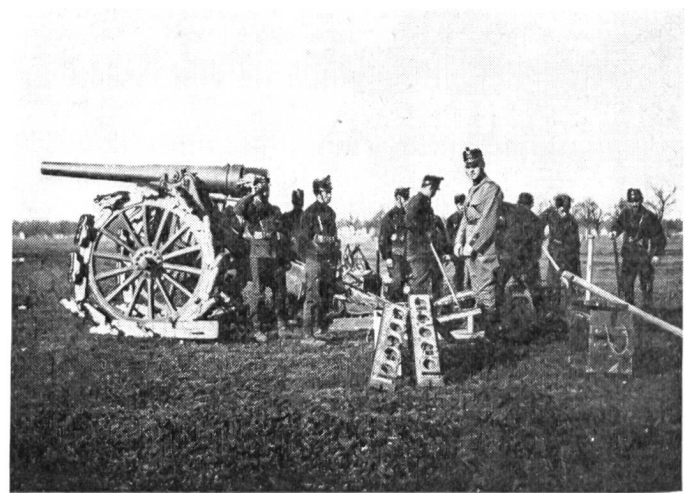
Die schwere Artillerie bestand aus 15-cm-Haubitzen und 12-cm-Radgürtelkanonen (im Bild), die damals aber schon ein beträchtliches Alter aufwiesen
