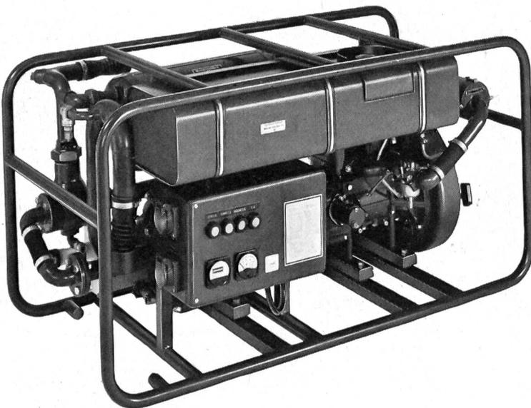
Generator-Pumpen-Aggregat für Wasseraufbereitungs-Anlagen
