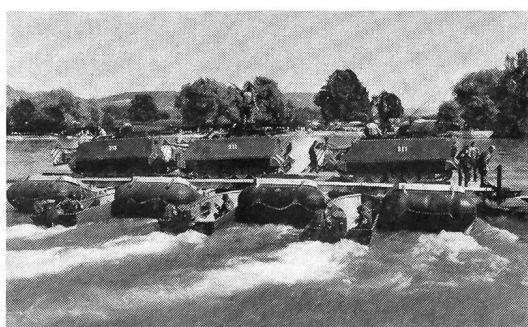
Demonstration einer Pontonierkompanie auf dem Wasser: Pontonfähre mit drei Schützenpanzern
