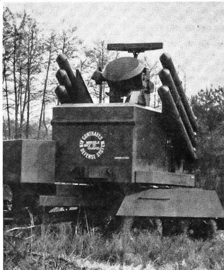
Das von der Contraves AG, Zürich, mit firmeneigenen Mitteln entwickelte Feuerleitgerät Skyguard wurde bekanntlich von Anfang an zur Steuerung von Geschützen und Lenk Waffen ausgelegt. In Le Bourget präsentierte nun die zur Bührlé Holding AG gehörende Firma das autonome Lenkwaffensystem Skyguard M. Bestehend aus dem Feuerleitgerät Skyguard und einer Werfereinheit, handelt es sich dabei um ein hochmobiles, unabhängiges Allwetter-Lenk waffensystem für die Bekämpfung von
