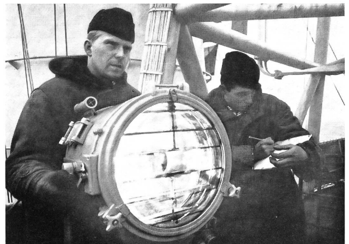
Mit dem Signalscheinwerfer auf der Kommandobrücke eines Zerstörers werden Befehle und Nachrichten von Schiff zu Schiff gegeben. Dies ist nach wie vor auch im Zeichen von modernen Funkmitteln nötig.
