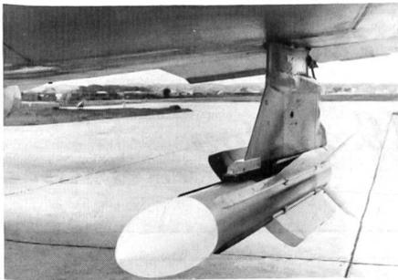
Antrieb: Zweistufiger Feststoffraketenmotor Thomson-Brandt/SNPE Angéle
